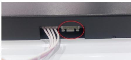
Рис. 2 Разъём модуля Wi-Fi
