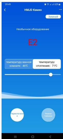
Рис. 20 Отображение кода неисправности
