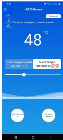
Рис. 17 Установка температуры отопления
