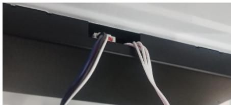
Рис. 3 Подключение разъёма модуля Wi-Fi
